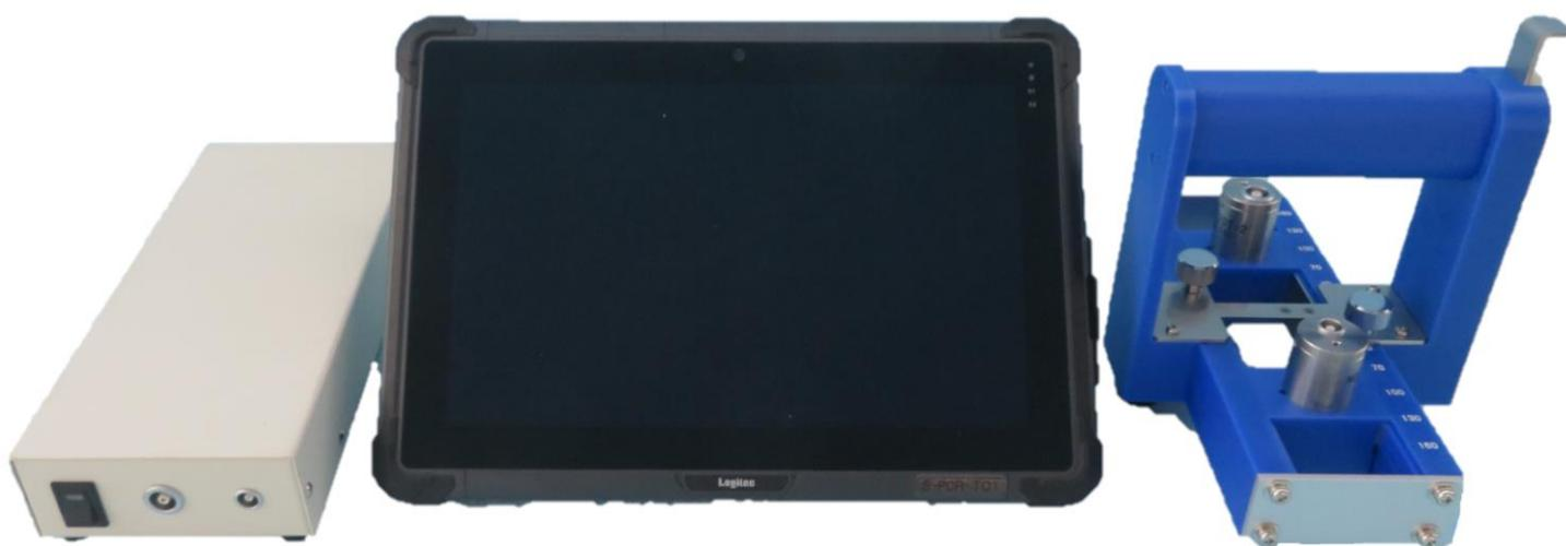
超音波を用いて非破壊により短時間で曲げ強度の測定が可能です。
